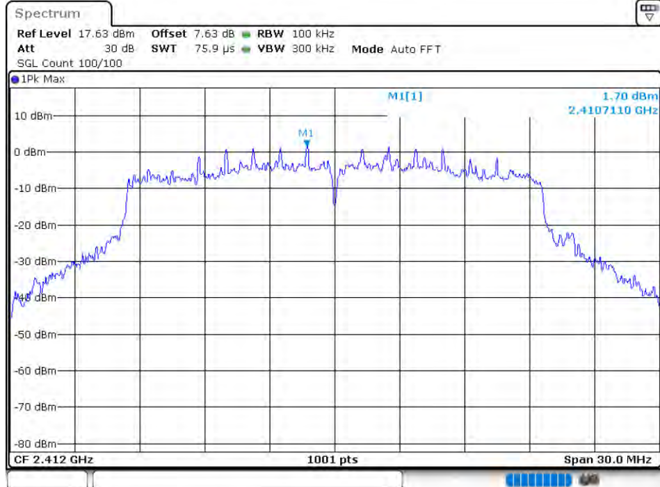
Band Edge NVNT 802.11ax20 2412MHz Ant 1 Ref
