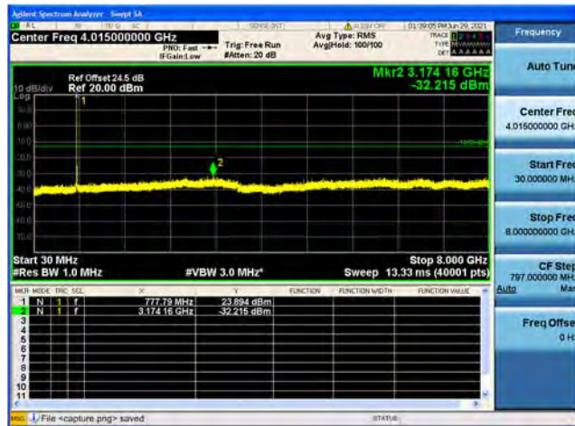
Band13 / 10MHz / Mid CH / QPSK
