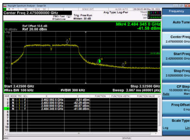
,Plot 3,30MHz~2310MHz-802.11n(HT40) ,2437MHz
