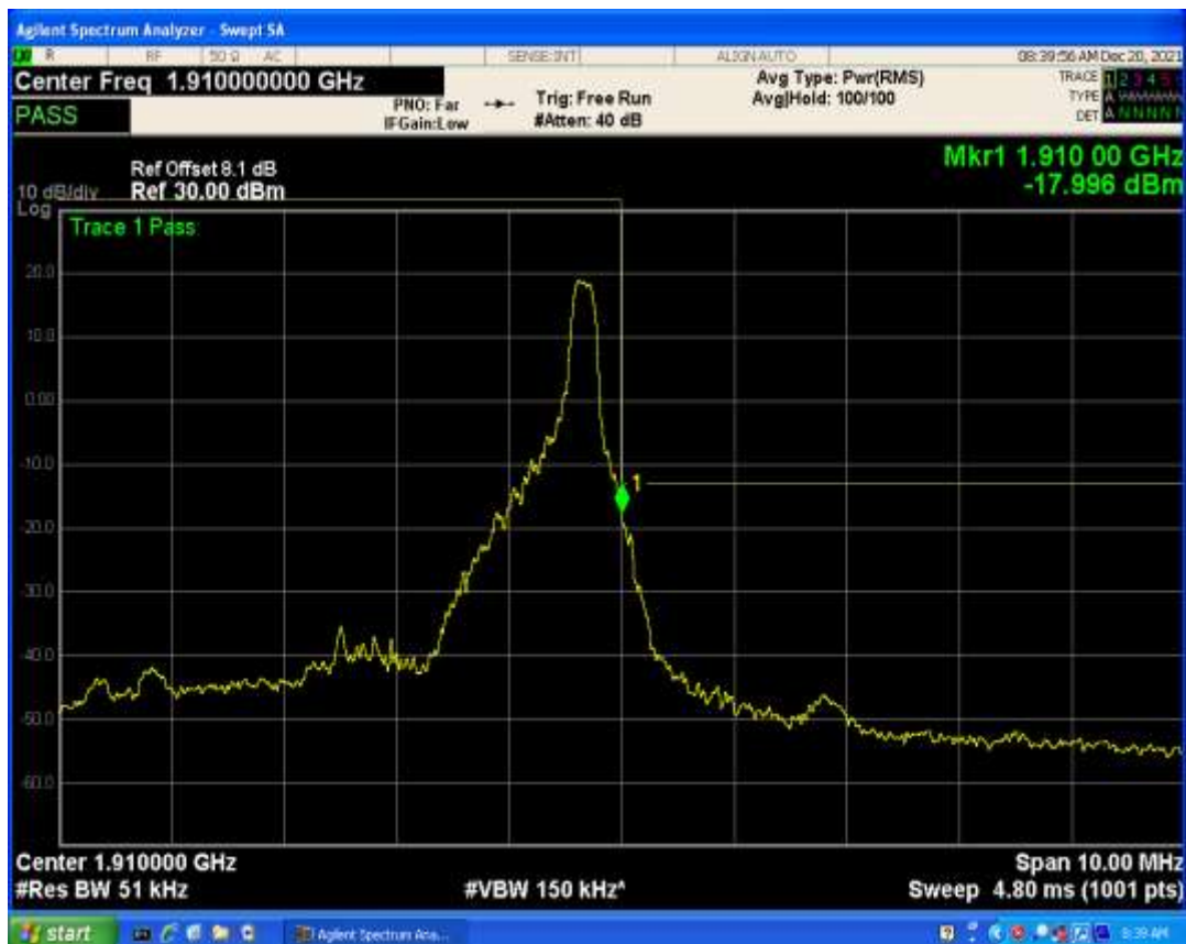
Band2 QPSK BW=10MHz Channel=18650 RB Size=1 Position=#0
