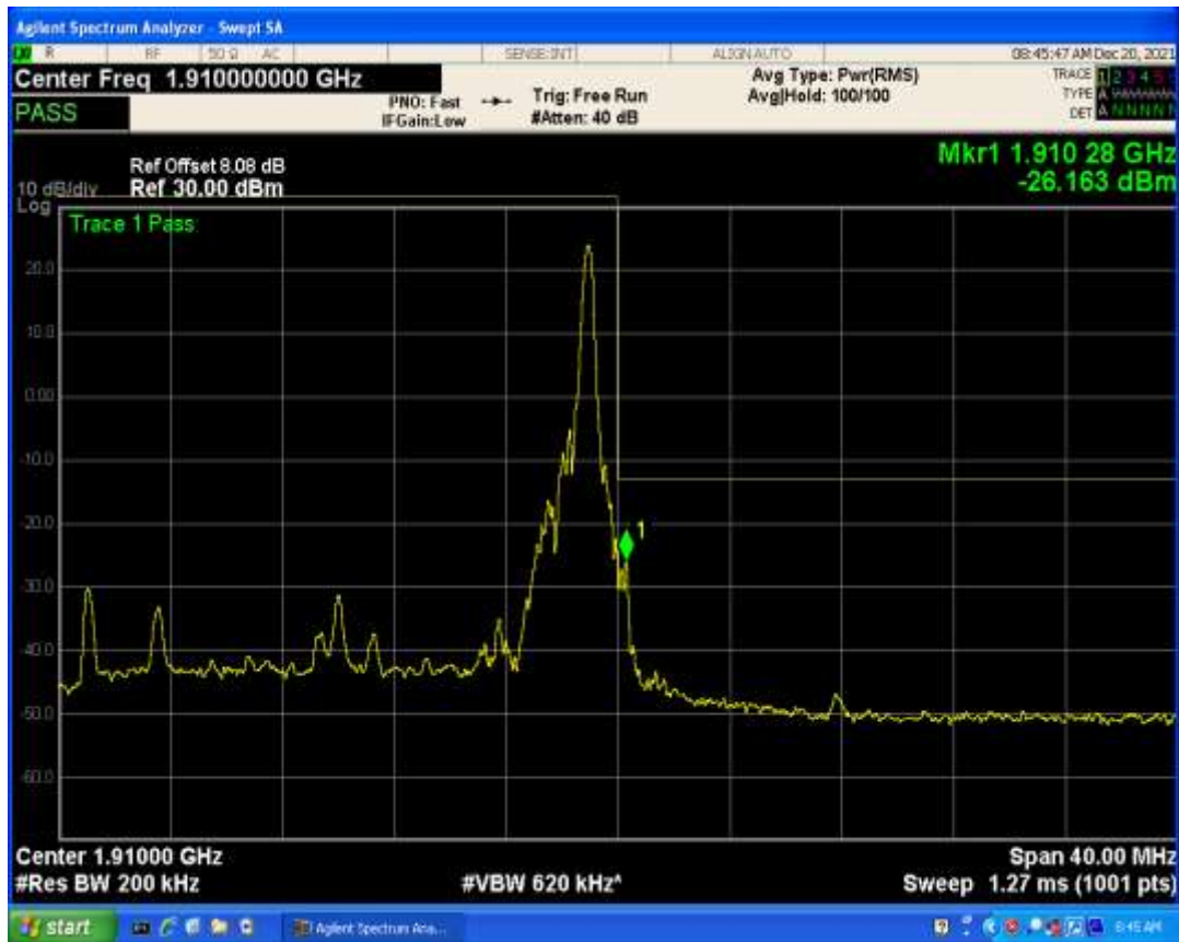
Band2 QPSK BW=20MHz Channel=19100 RB Size=100 Position=#0
