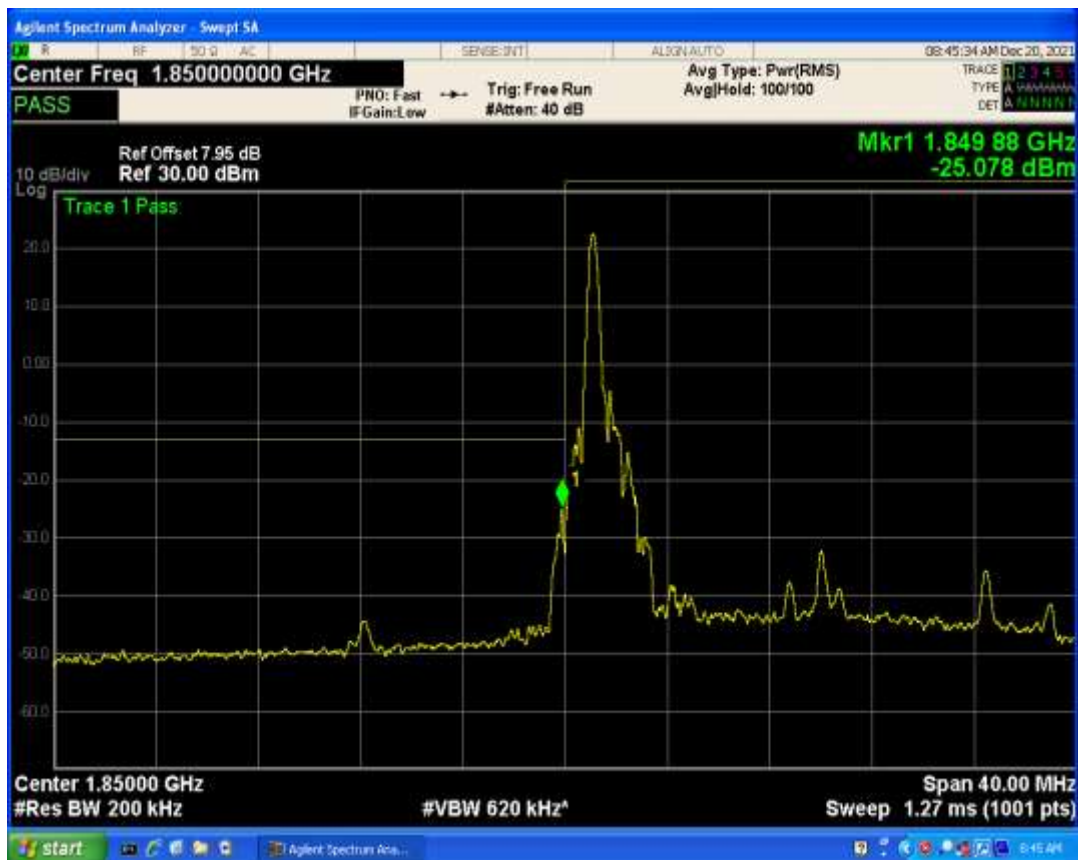
Band2 QPSK BW=20MHz Channel=18700 RB Size=100 Position=#0
