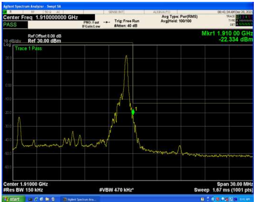
Band2 QPSK BW=20MHz Channel=18700 RB Size=1 Position=#0
