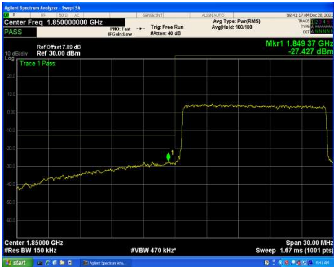
Band2 QPSK BW=15MHz Channel=19125 RB Size=1 Position=#0
