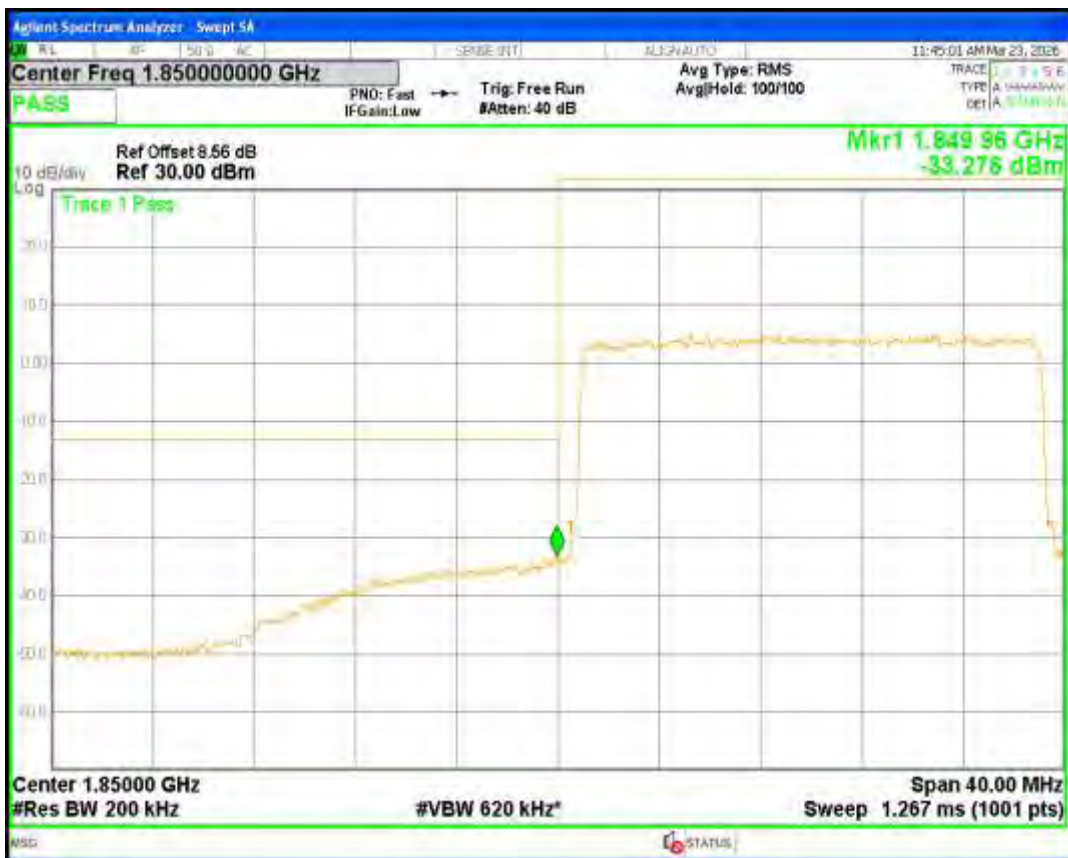
Band2 QPSK BW=20MHz Channel=19100 RB Size=100 Position=#0
