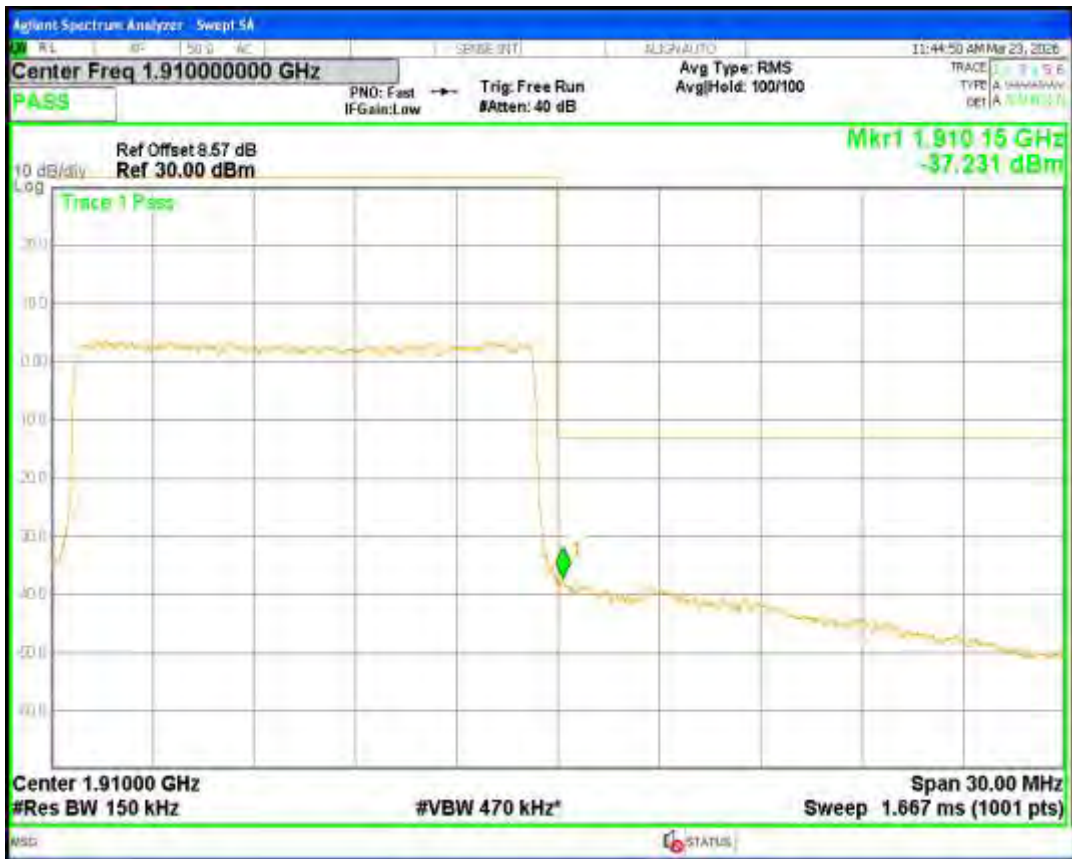
Band2 16QAM BW=20MHz Channel=18700 RB Size=100 Position=#0
