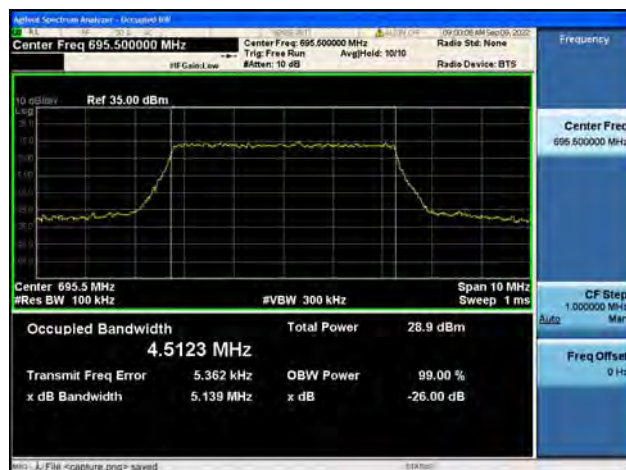
Band71 / 5MHz / QPSK/ High CH
