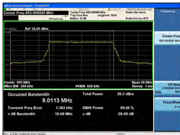
Band71 / 10MHz / QPSK/ High CH
