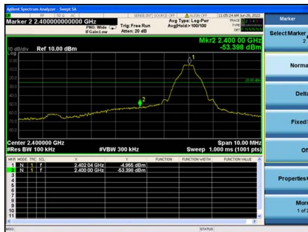
Left Band edge hopping off
