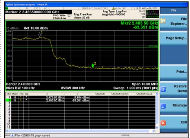
Right Band edge hopping on
