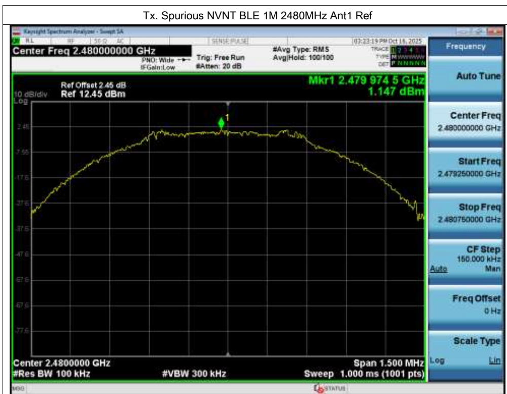
Tx. Spurious NVNT BLE 1M 2480MHz Ant1 Emission
