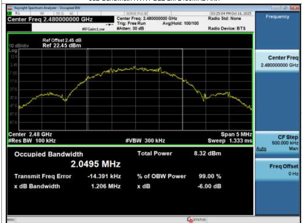
-6dB Bandwidth NVNT BLE 2M 2480MHz Ant1
