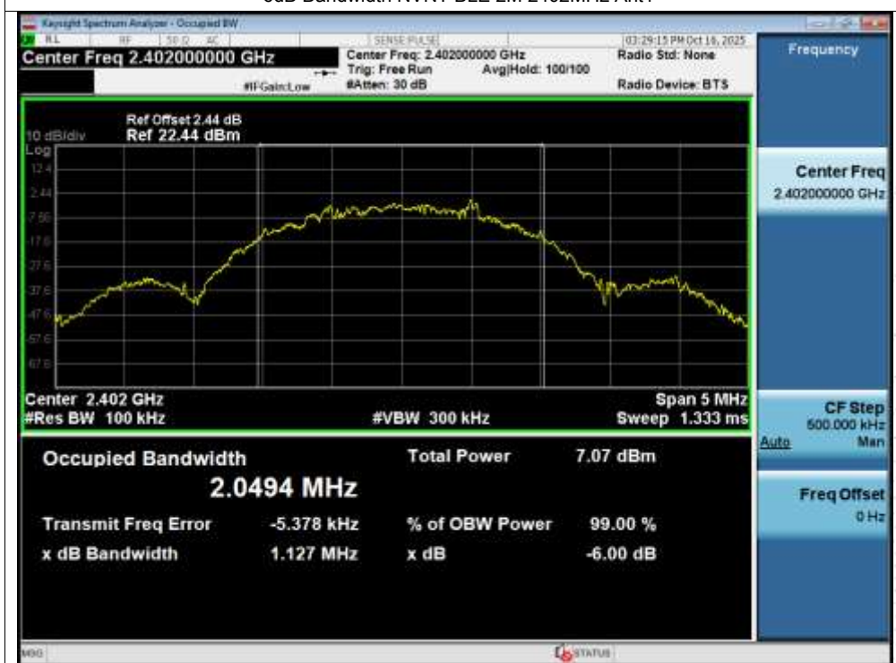
-6dB Bandwidth NVNT BLE 2M 2402MHz Ant1
