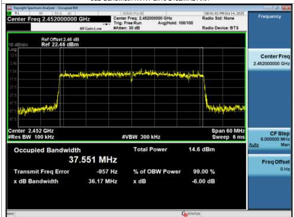
-6dB Bandwidth NVNT ax40 2452MHz Ant1
