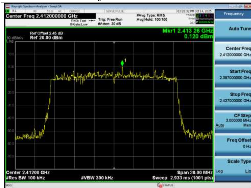
Band Edge NVNT ax20 2412MHz Ant1 Emission
