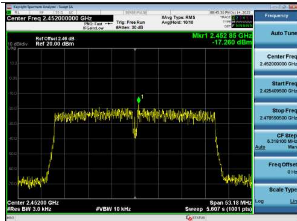
PSD NVNT n40 2452MHz Ant1
