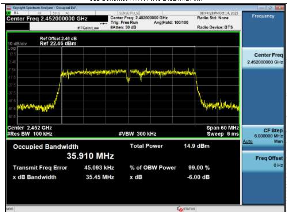
-6dB Bandwidth NVNT n40 2452MHz Ant1
