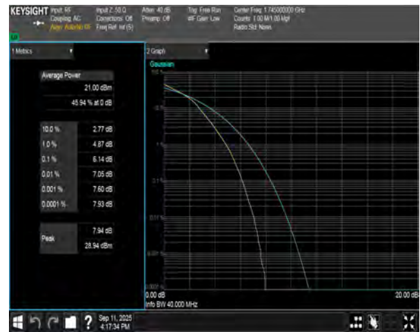
n66 SCS=15kHz DFT_16QAM BW=30MHz Channel=349000 RB=160@0
