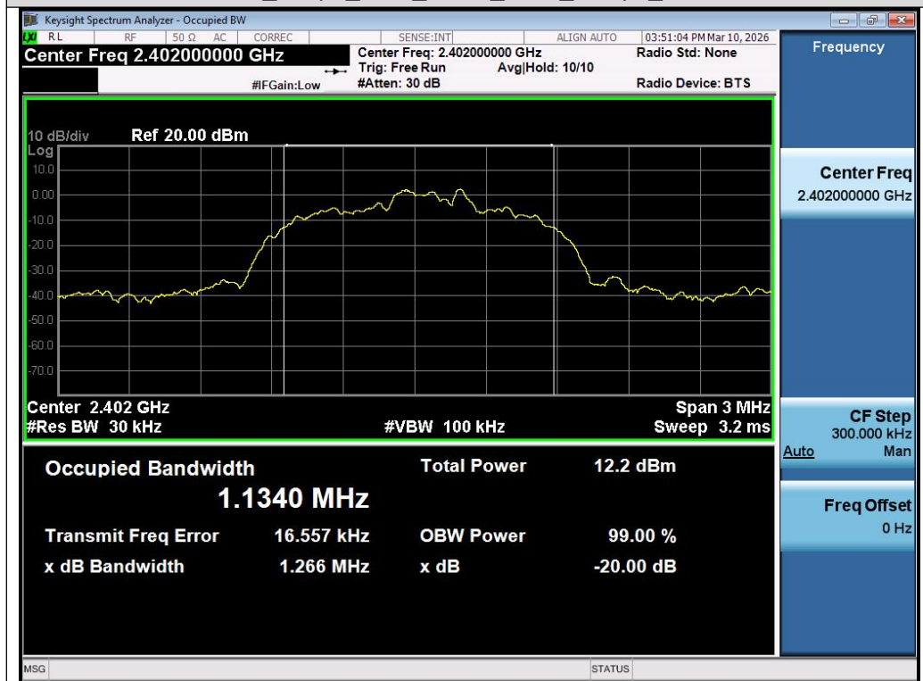
Test_Graph_EDR_ANT1_2402_3Mbps_OBW
