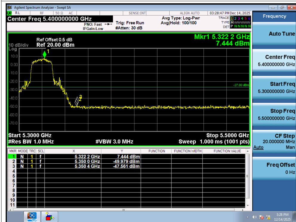
Band Edge NVNT ac20 5320MHz High Ant1
