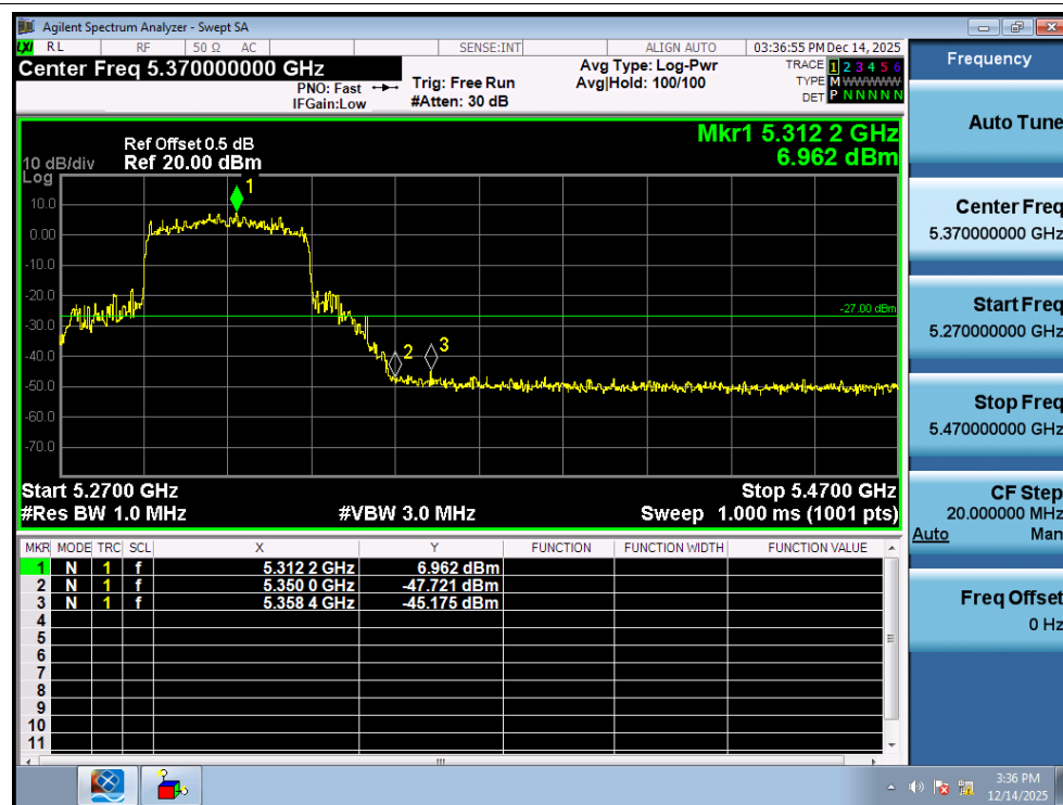
Band Edge NVNT ax40 5310MHz High Ant1
