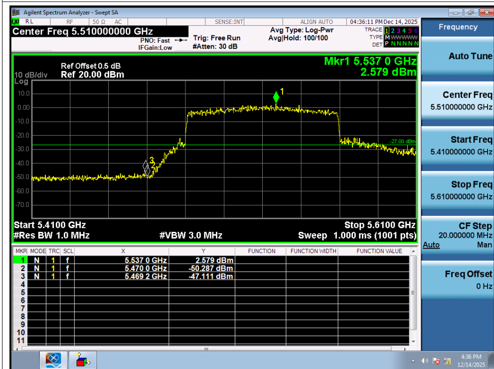
Band Edge NVNT ax80 5530MHz Low Ant1
