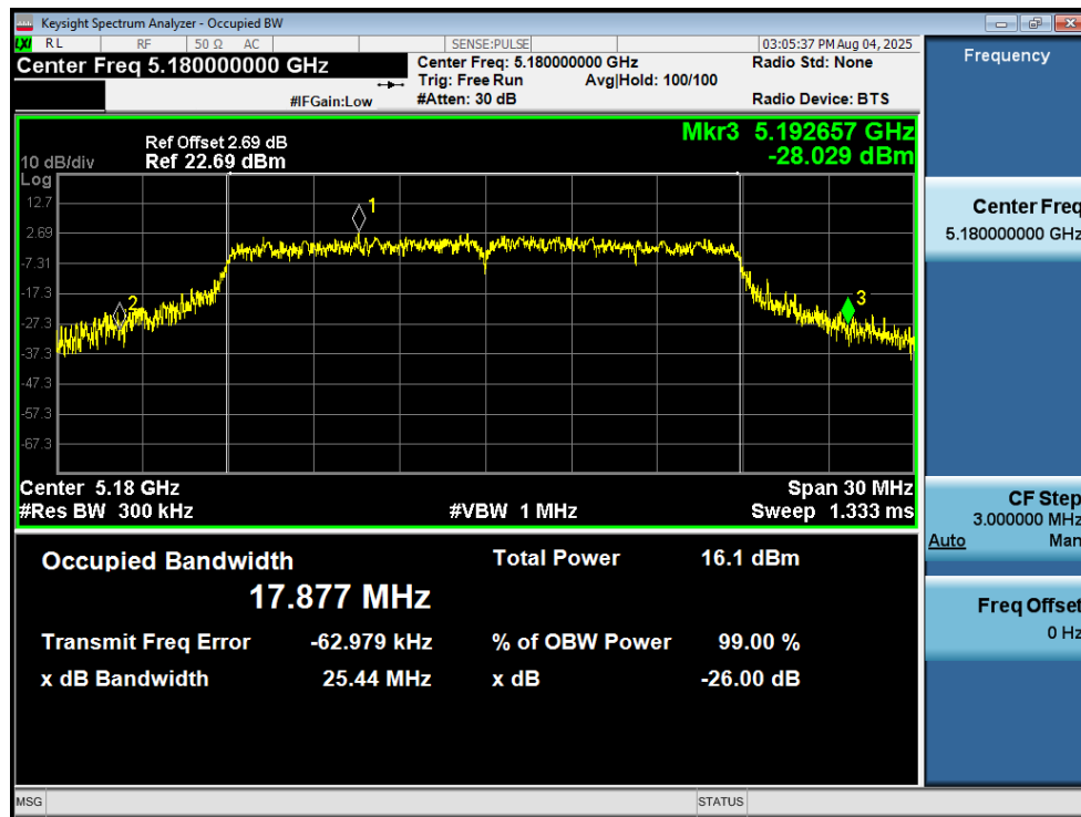
-26dB Bandwidth NVNT ac20 5180MHz Ant1
