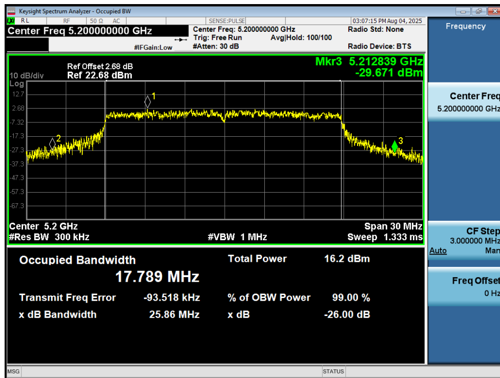
-26dB Bandwidth NVNT ac20 5200MHz Ant1
