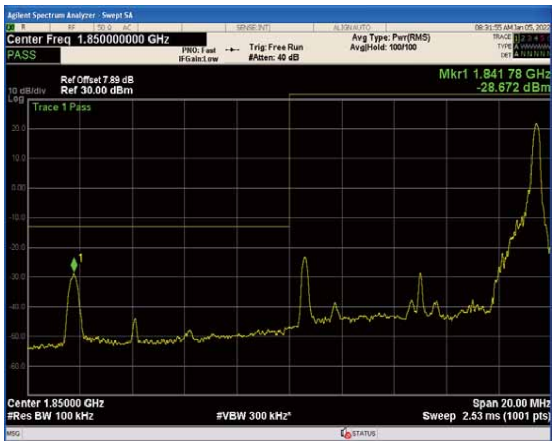
Band2 QPSK BW=10MHz Channel=18650 RB Size=1 Position=#0
