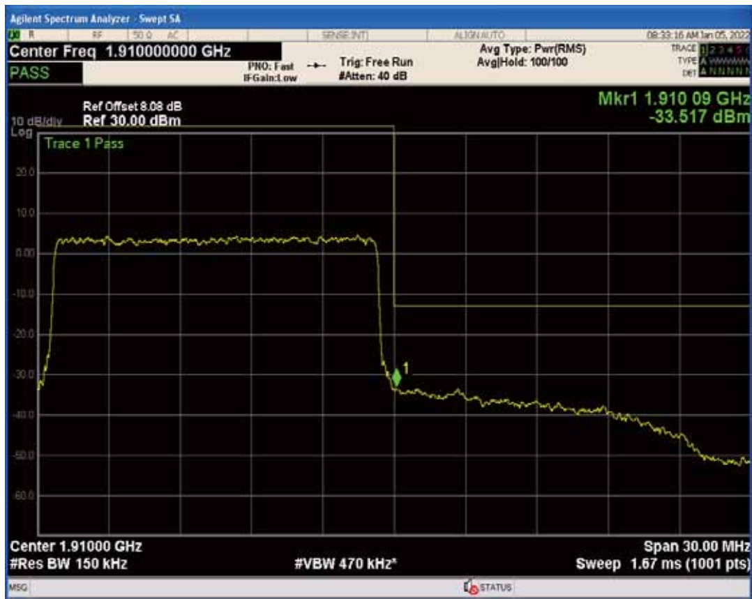
Band2 QPSK BW=20MHz Channel=18700 RB Size=1 Position=#0
