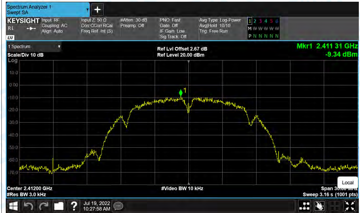
PSD NVNT b 2437MHz Ant1
