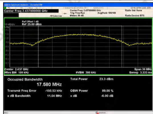
IEEE 802.11b_Channel 6_20MHz_Antenna 0
