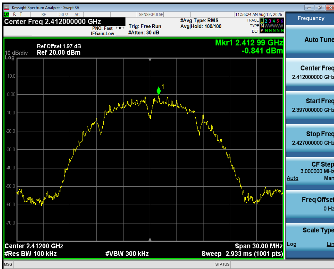
Band Edge NVNT b 2412MHz Ant1 Ref
