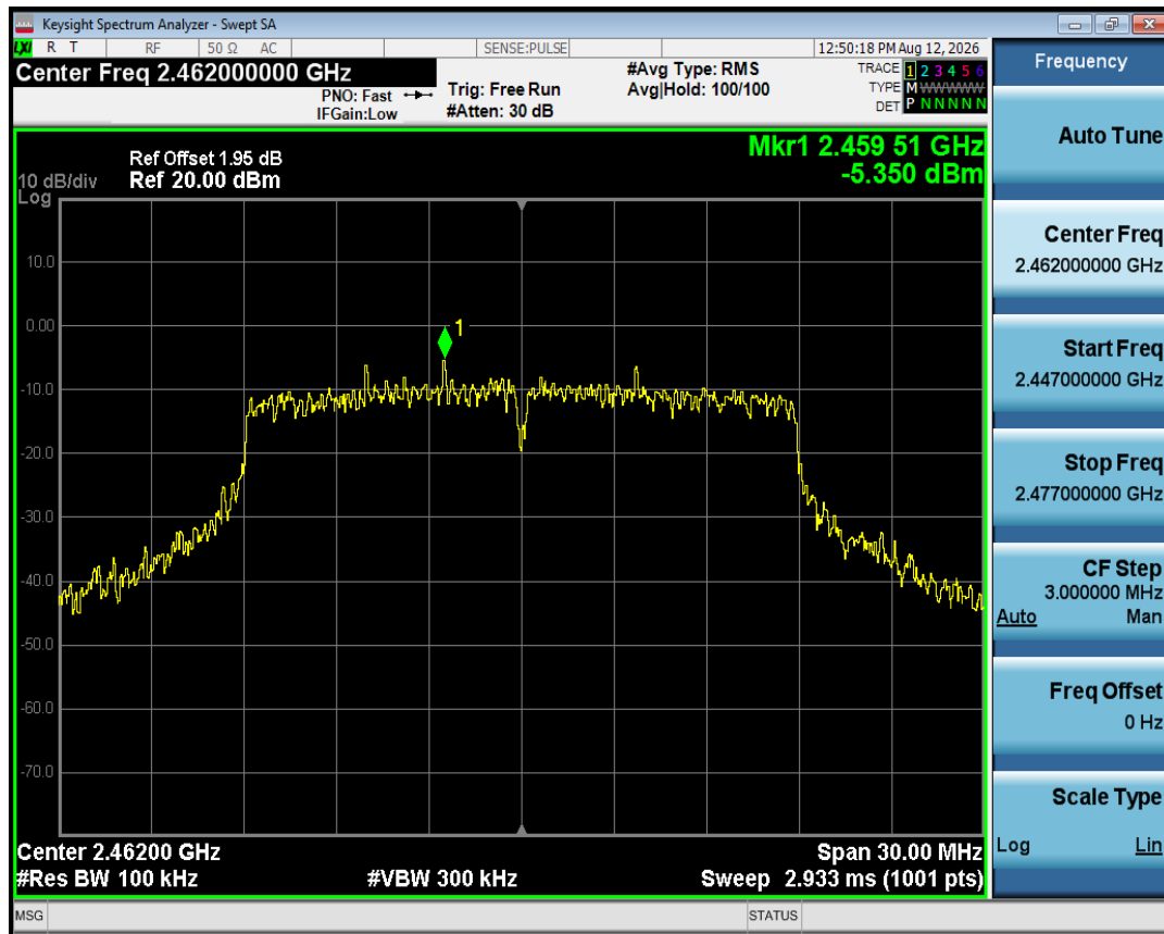
Band Edge NVNT n20 2462MHz Ant1 Ref
