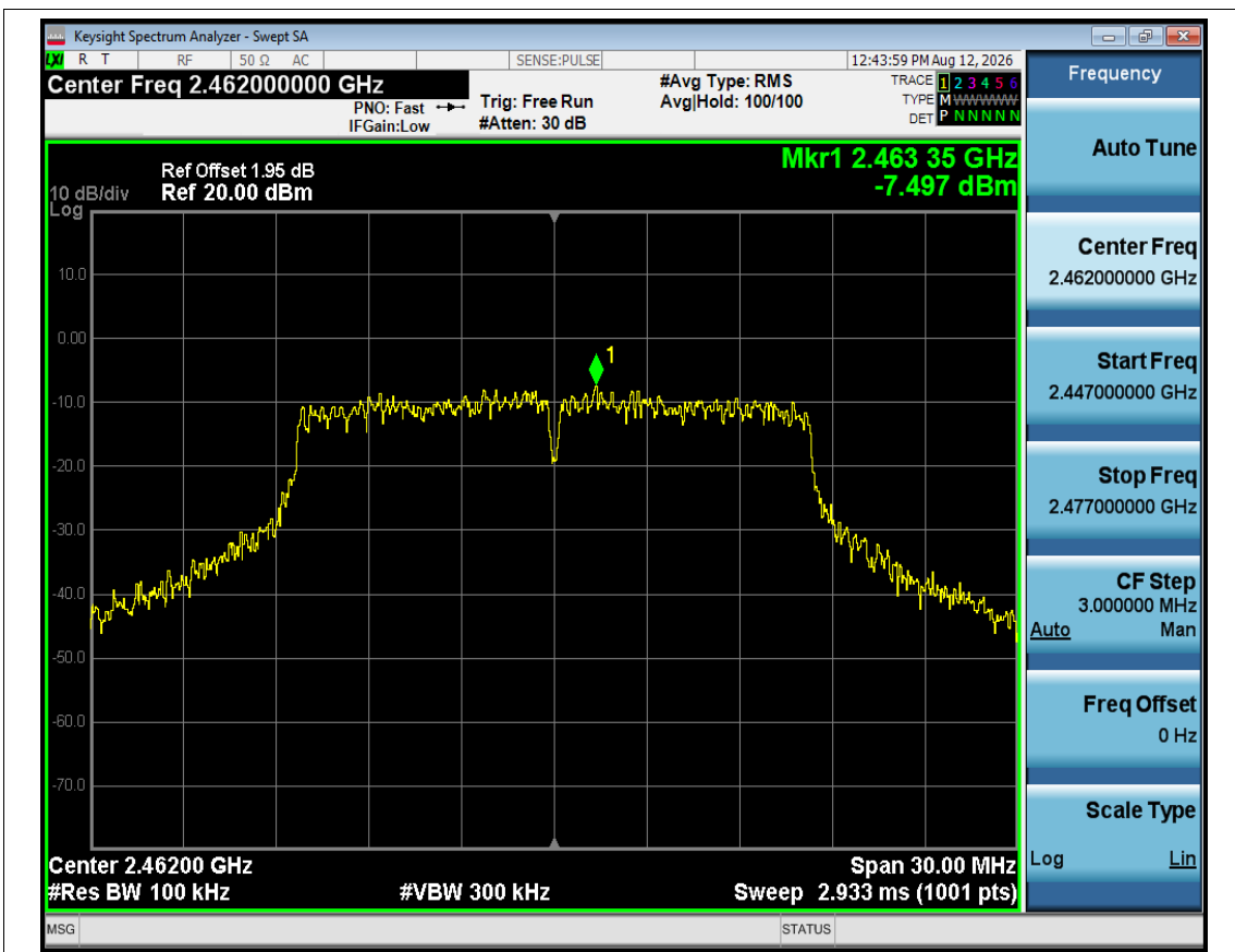
Band Edge NVNT g 2462MHz Ant1 Ref
