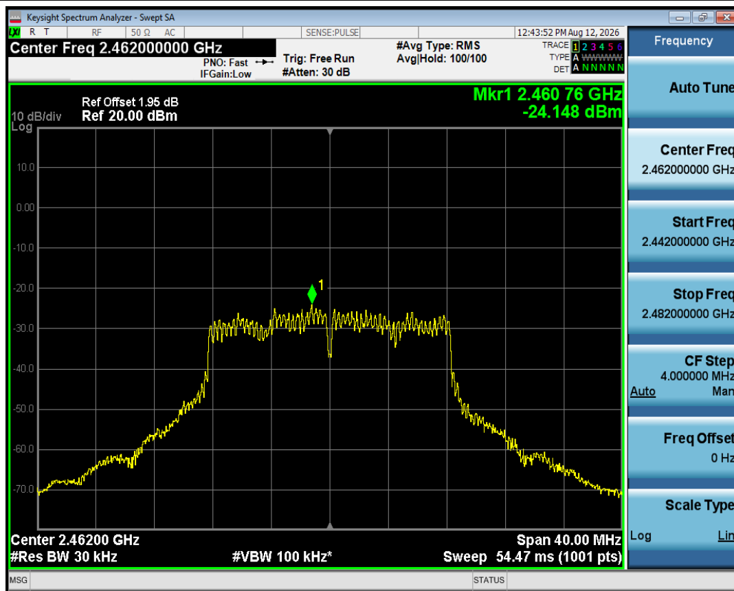
PSD NVNT g 2462MHz Ant1
