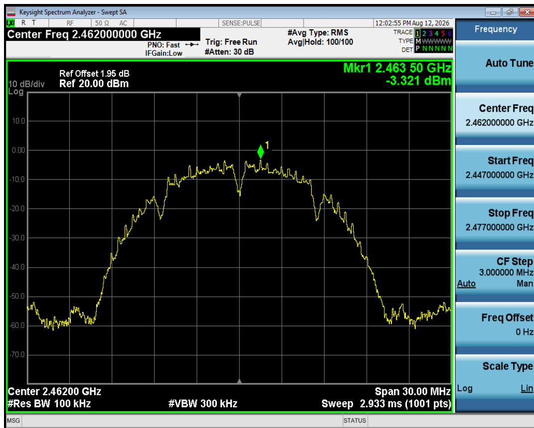
Band Edge NVNT b 2462MHz Ant1 Ref
