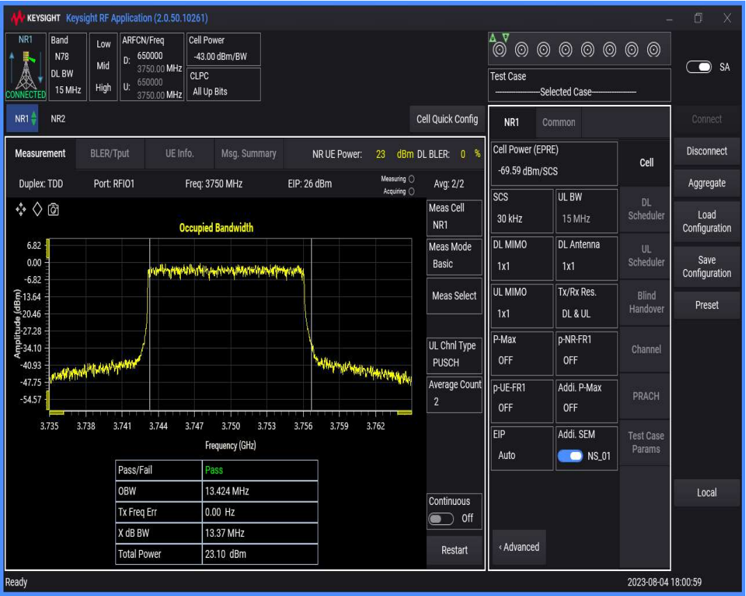
n78(3700-3800) SCS=30kHz DFT_QAM256 BW=20MHz Channel=650000 RB=50@0
