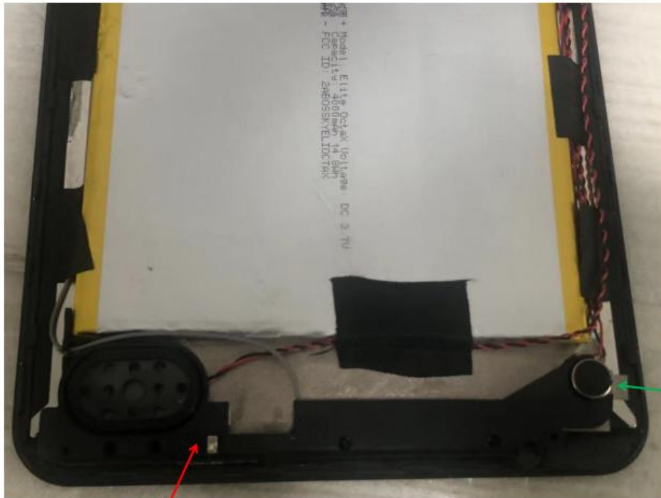
4G 主天线连接板背面贴 导电布接地
