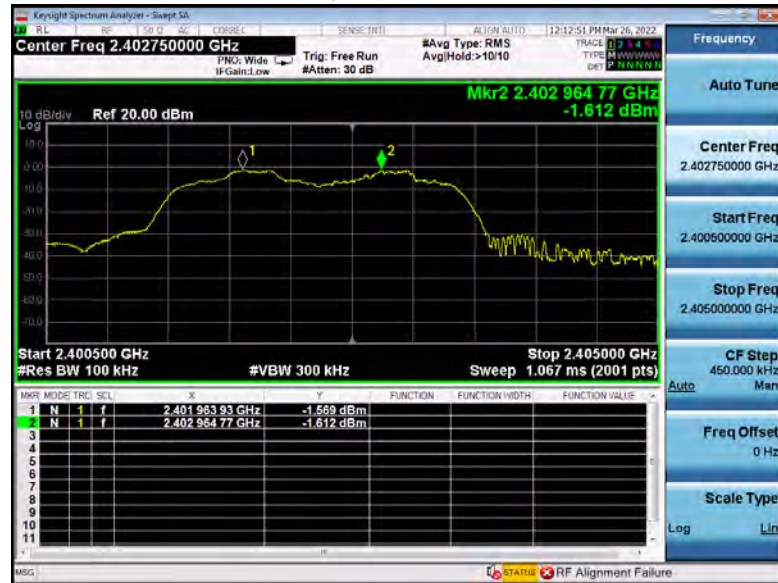
\pi/4 -DQPSK Low Channel
