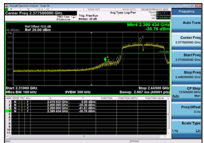
,Plot 2,Band Edge-802.11n(HT40) ,2452MHz,Ant0
