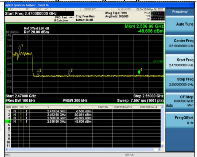
Right Band edge hopping on
