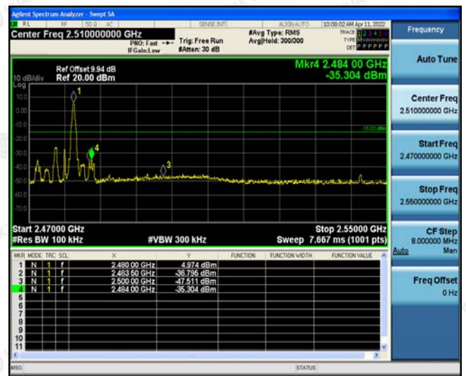
Right Band edge hopping off
