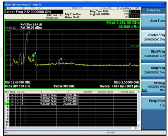
Right Band edge hopping off
