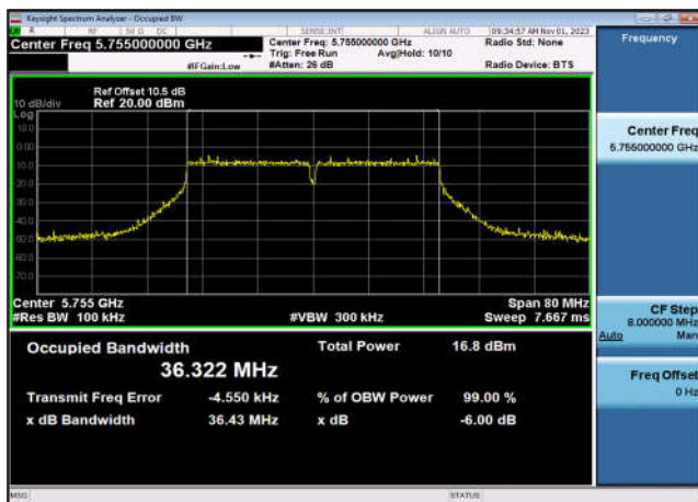
U-NII-3 6dB Bandwidth-802.11ac(40MHz) ,5755MHz,Ant9
