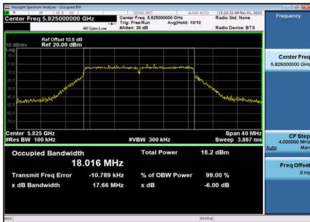
U-NII-3 6dB Bandwidth-802.11ac(40MHz) ,5755MHz,Ant9
