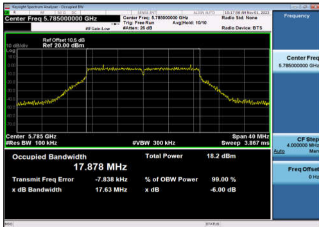
U-NII-3 6dB Bandwidth-802.11ac(20MHz) ,5825MHz,Ant9
