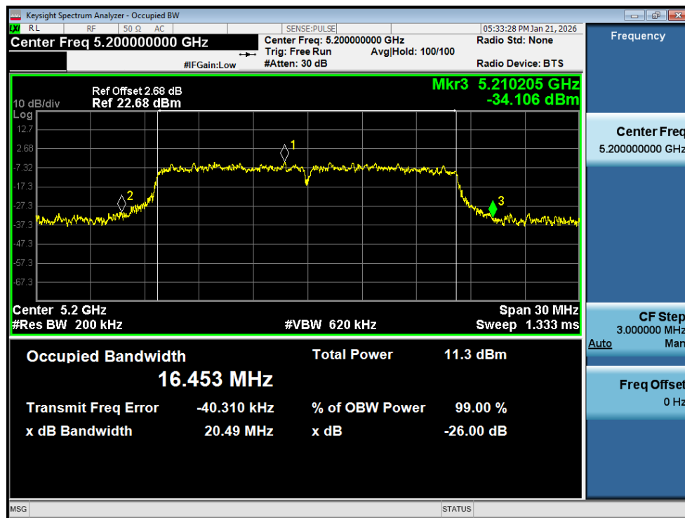
-26dB Bandwidth NVNT a 5200MHz Ant1
