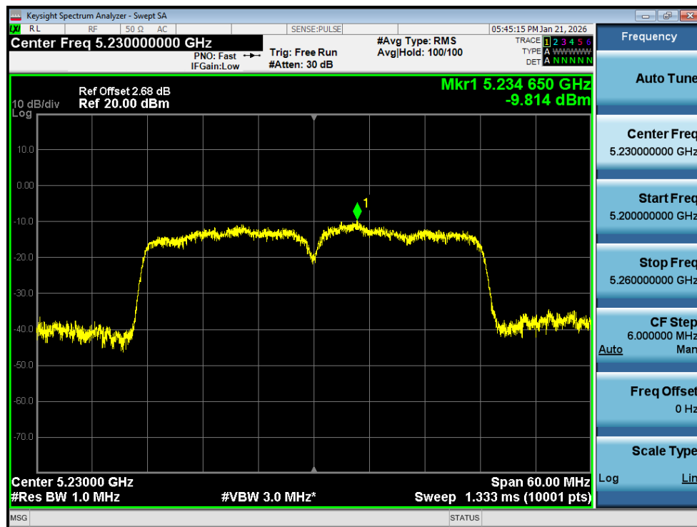
PSD NVNT n40 5230MHz Ant1
