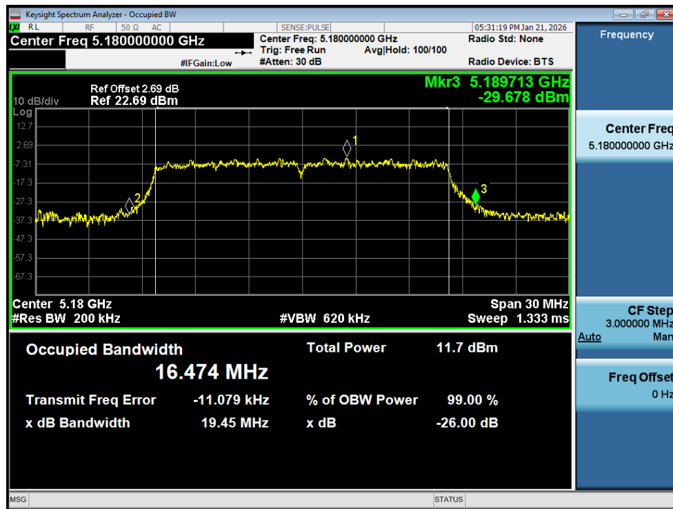
-26dB Bandwidth NVNT a 5180MHz Ant1
