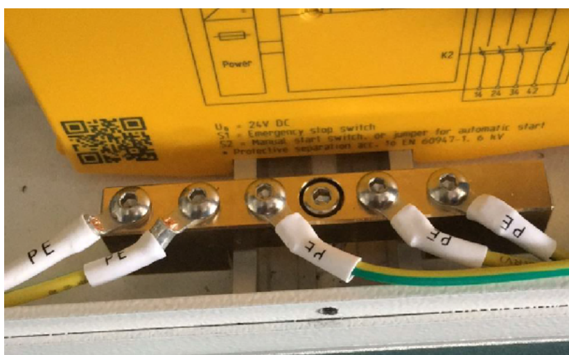
Pic 1.4-1 治具内部接地图示
