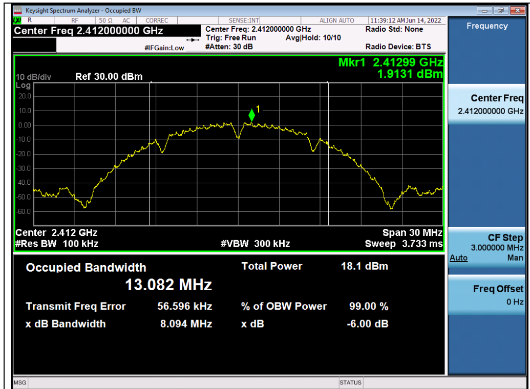
Test_Graph_802.11b_ANT1_2412_1Mbps_DTSBW
