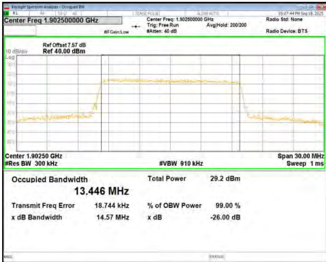
Band2 QPSK BW=20MHz Channel=18700 RB Size=100 Position=#0
