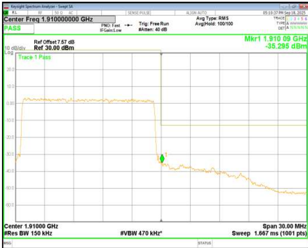
Band2 QPSK BW=20MHz Channel=18700 RB Size=100 Position=#0
