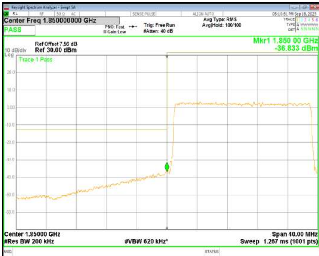
Band2 QPSK BW=20MHz Channel=19100 RB Size=100 Position=#0
