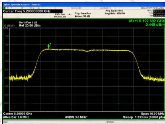
IEEE 802.11n_Channel 40_20MHz_Antenna 0
