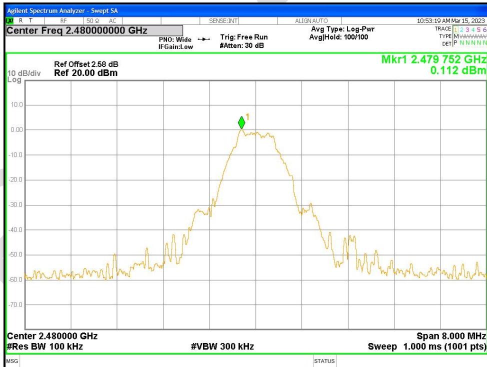
Band Edge NVNT BLE 2480MHz Ant1 Emission
