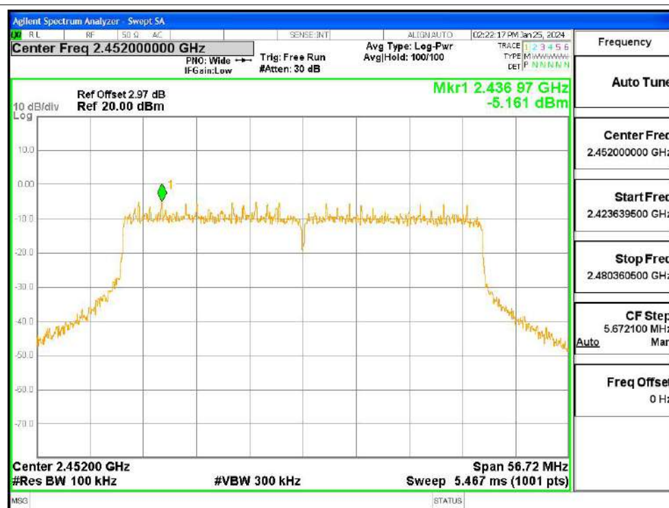
PSD NVNT ax40 2452MHz Ant1
