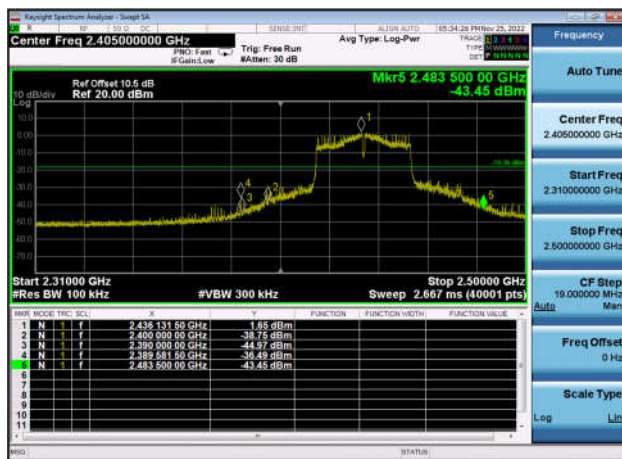
,Plot 2,Band Edge-802.11n(HT40) ,2437MHz,Ant0
