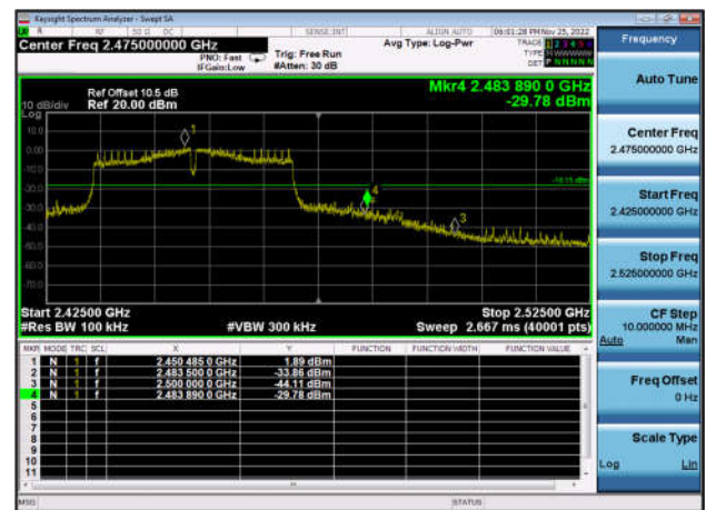
,Plot 2,Band Edge-802.11n(HT40) ,2452MHz,Ant0
