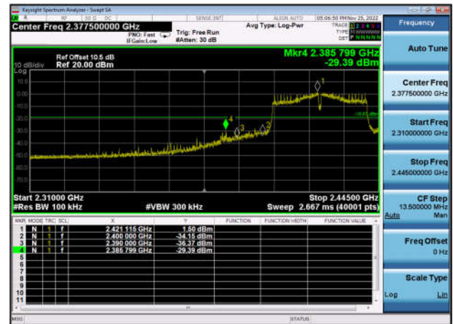
,Plot 2,Band Edge-802.11n(HT40) ,2452MHz,Ant0
