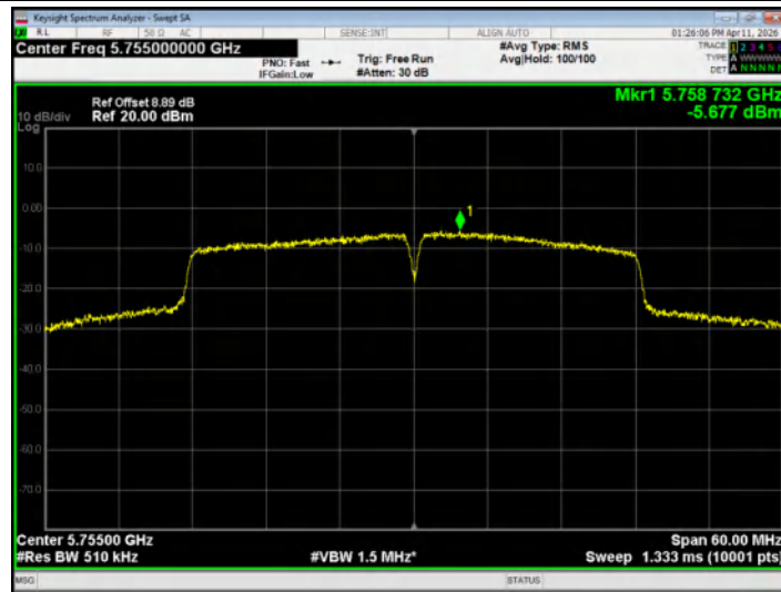
PSD NVNT n40 5795MHz Ant1
