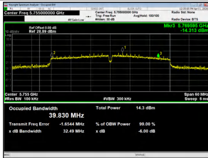
-6dB Bandwidth NVNT n40 5795MHz Ant1
