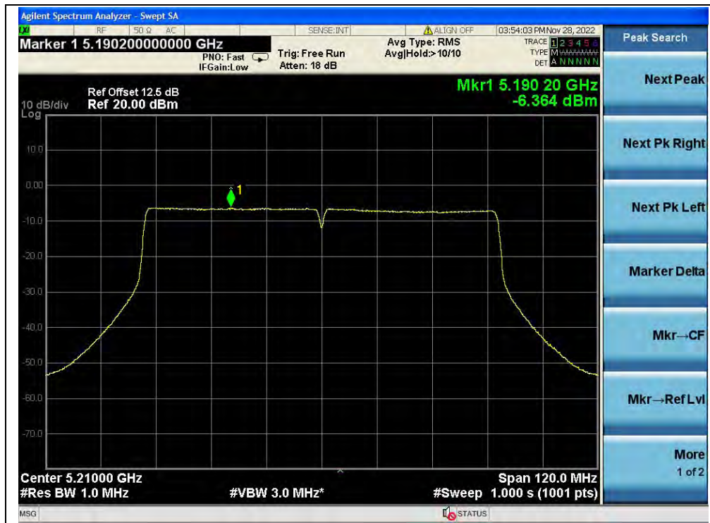
(Channel 42, 5210MHz, 802.11ac (VHT80), ANT0)
