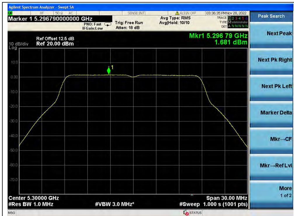
(Channel 60, 5300MHz, 802.11ac (VHT20), ANT0)
