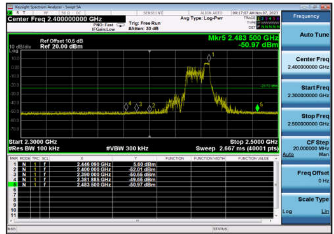
,Plot 2,Band Edge-802.11ax(HE20 _RU52_4),2462MHz,Ant6
