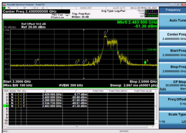
,Plot 2,Band Edge-802.11ax(HE20 _RU52_1),2462MHz,Ant7
