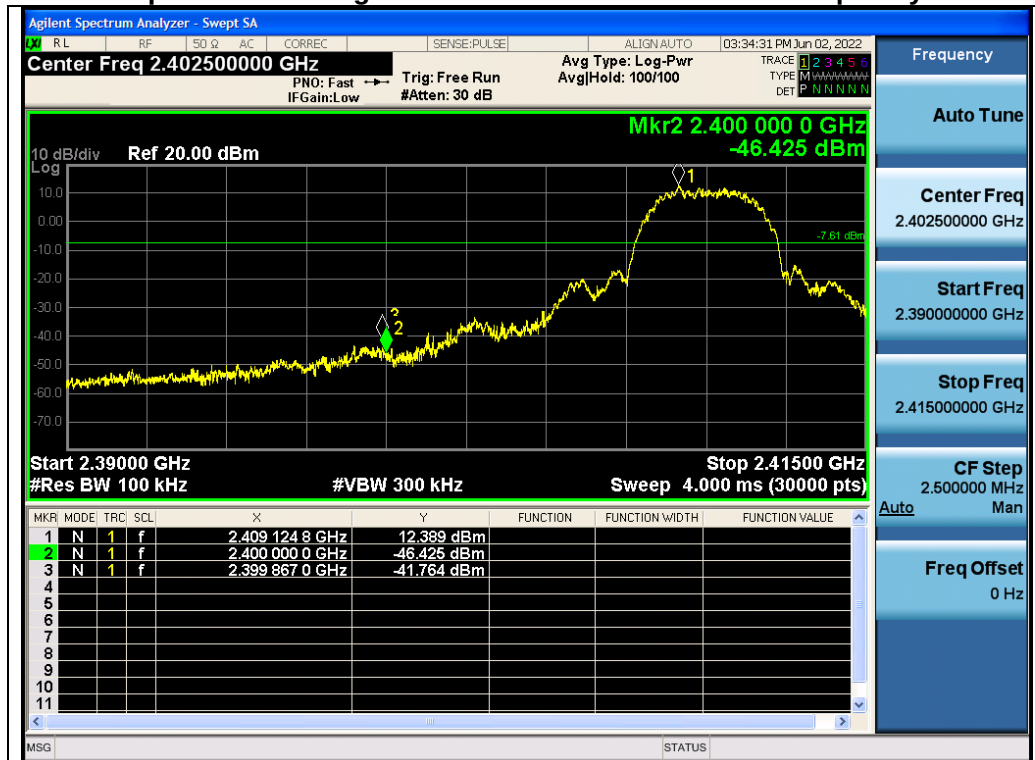
Test_Graph_GFSK_ANT1_2410_Lower Band Edge Emissions
