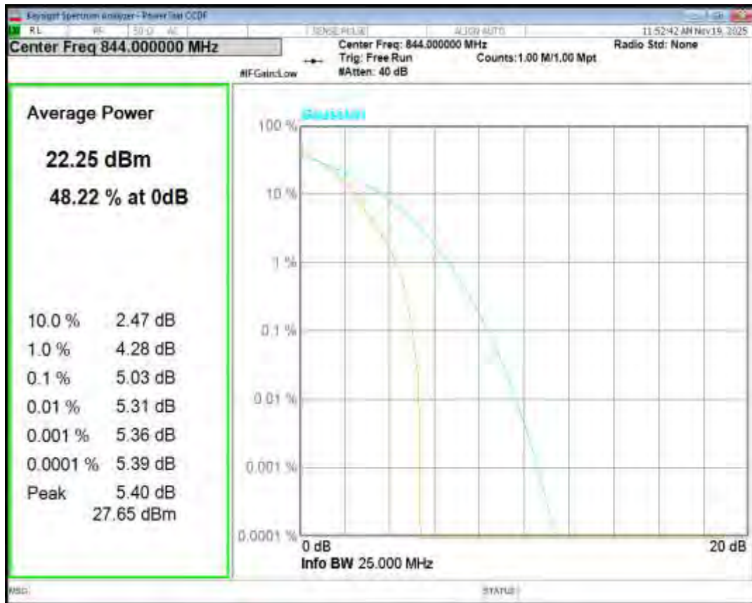
Band26(824-849) QPSK BW=15MHz Channel=26865 RB Size=1 Position=#0
