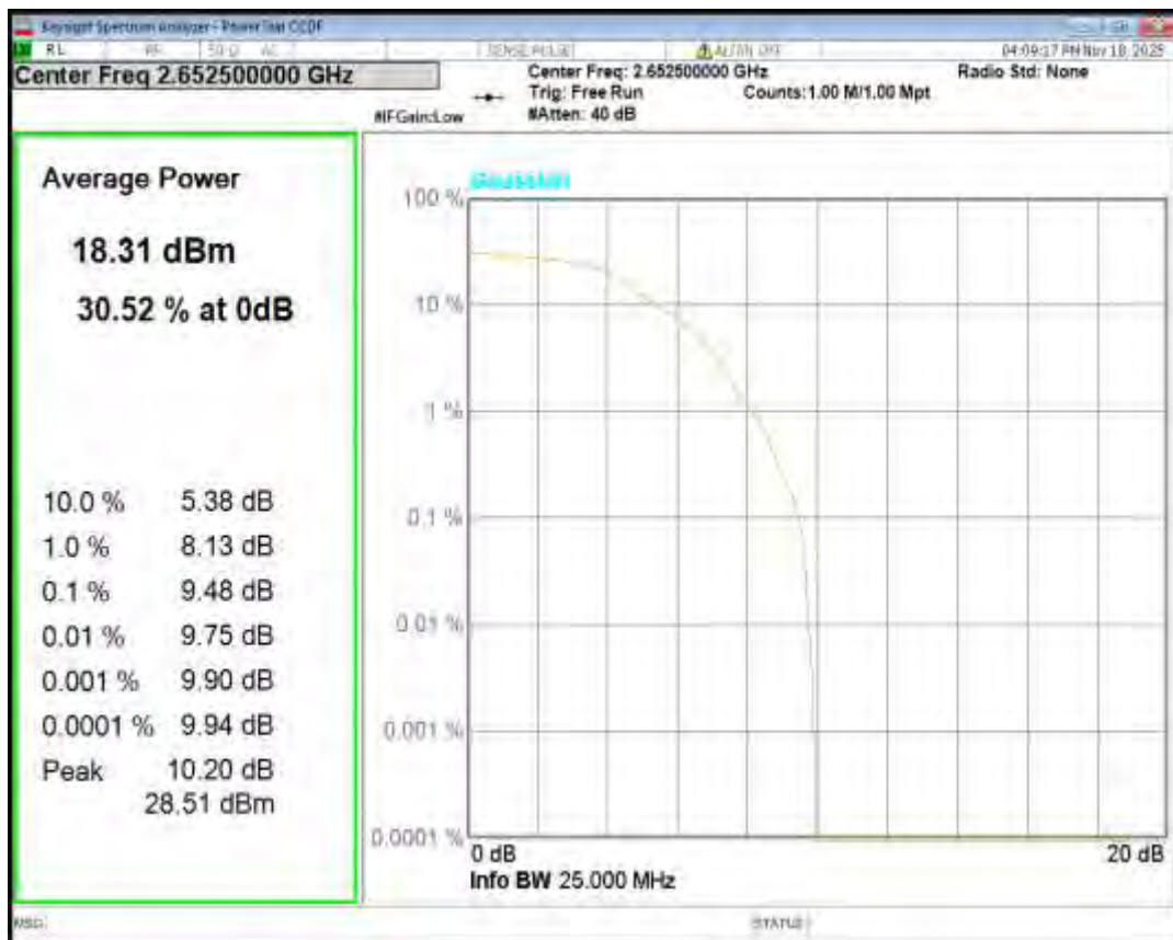
Band41(2555-2655) QPSK BW=10MHz Channel=40290 RB Size=1 Position=#0
