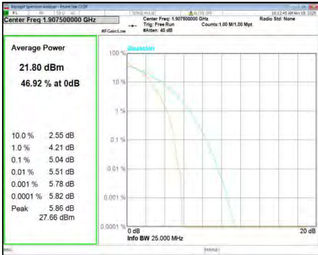
Band2 QPSK BW=10MHz Channel=18650 RB Size=1 Position=#0
