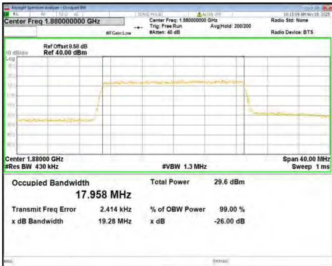
Band2 QPSK BW=20MHz Channel=19100 RB Size=100 Position=#0
