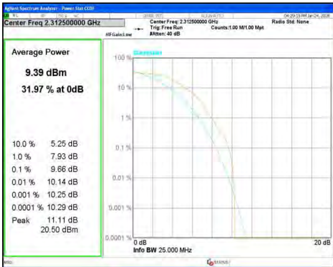
Band40(2305-2315) QPSK BW=10MHz Channel=38750 RB Size=1 Position=#0
