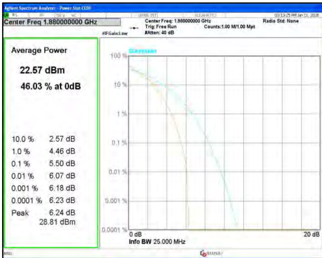
Band2 QPSK BW=15MHz Channel=19125 RB Size=1 Position=#0
