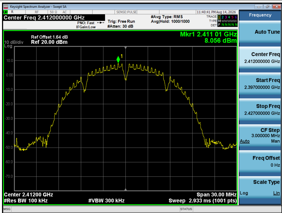
Band Edge NVNT b 2412MHz Ant1 Ref
