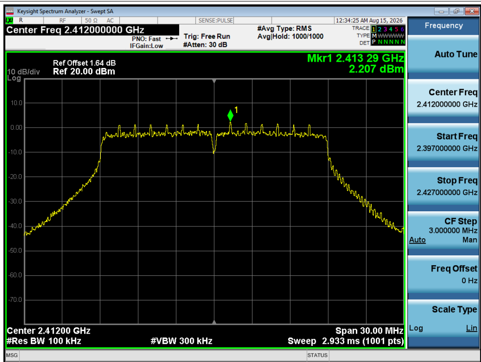
Band Edge NVNT n20 2412MHz Ant1 Ref
