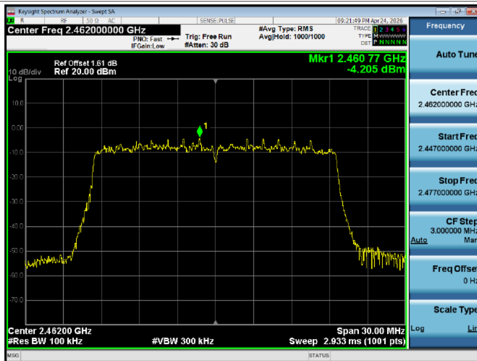
Band Edge NVNT ax20 2462MHz Ant2 Ref
