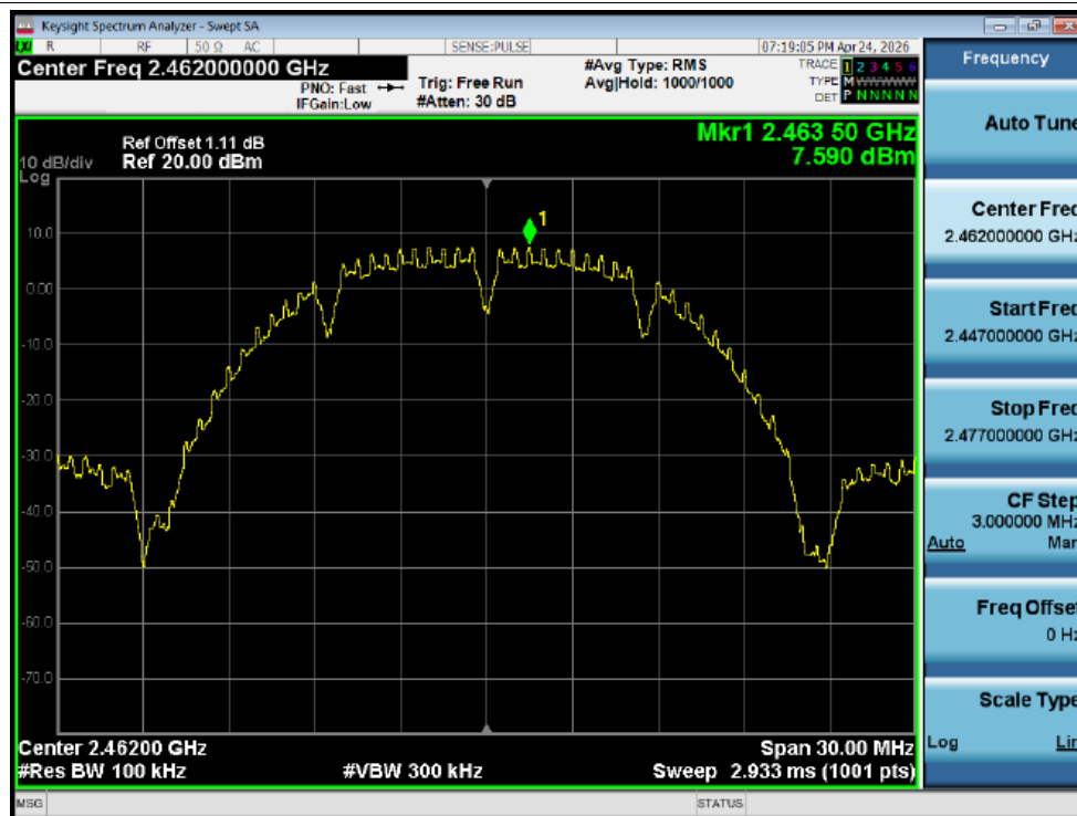
Band Edge NVNT b 2462MHz Ant2 Ref
