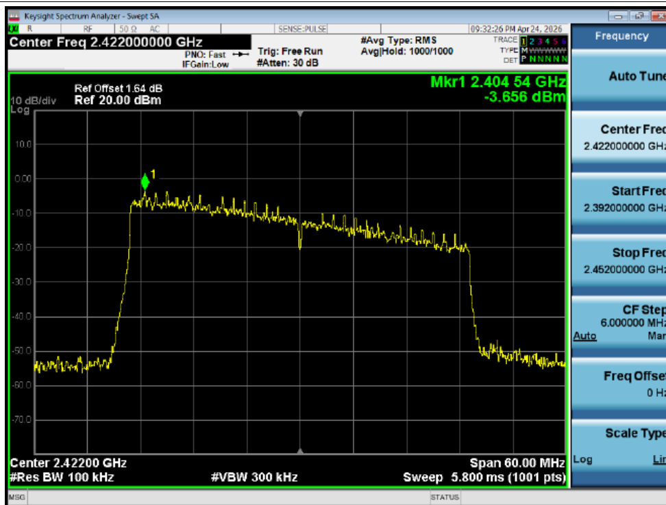
Band Edge NVNT ax40 2422MHz Ant1 Ref
