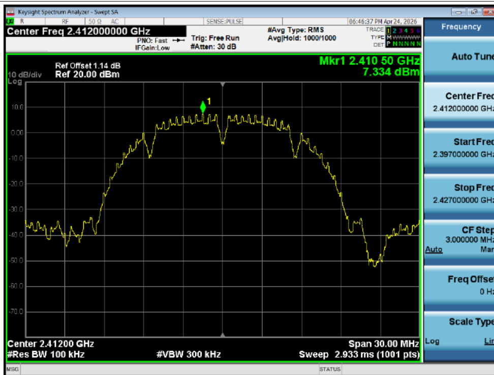
Band Edge NVNT b 2412MHz Ant1 Ref
