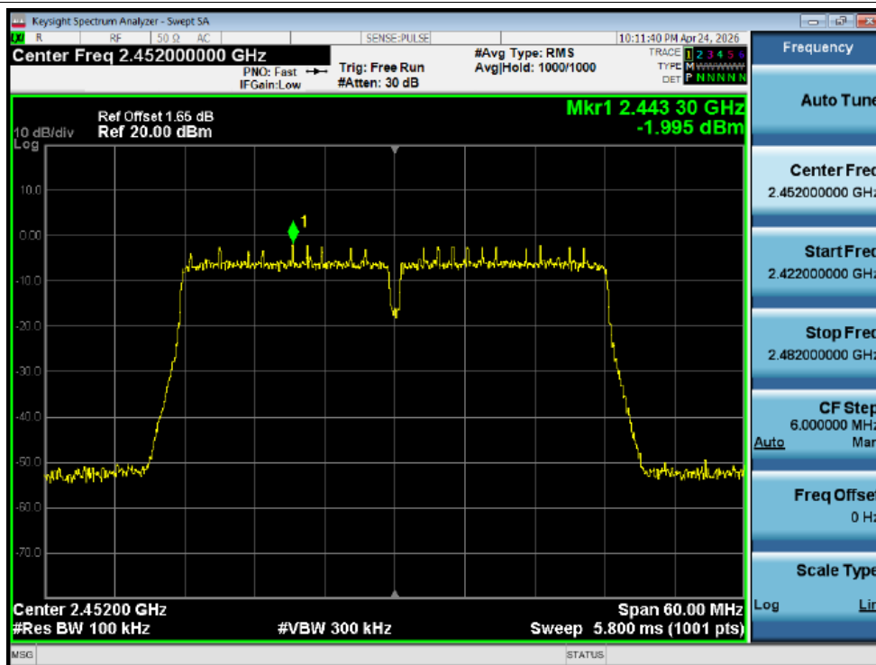
Band Edge NVNT n40 2452MHz Ant1 Ref
