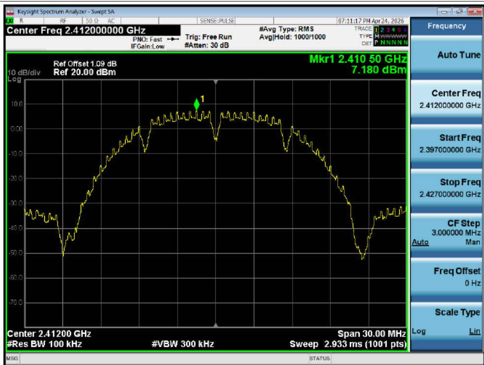
Band Edge NVNT b 2412MHz Ant2 Ref
