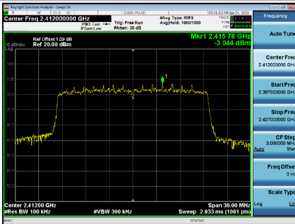
Band Edge NVNT ax20 2412MHz Ant2 Ref
