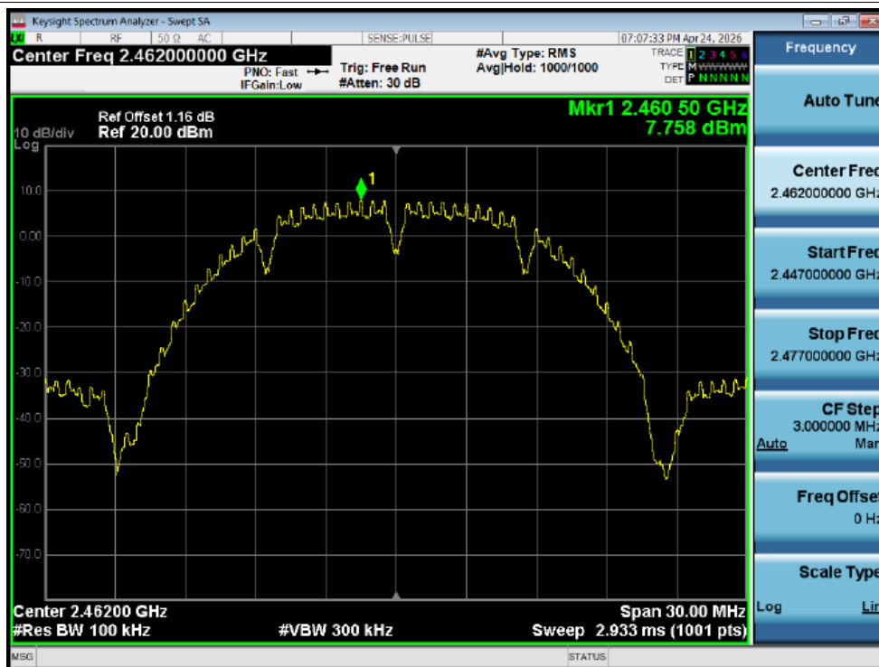
Band Edge NVNT b 2462MHz Ant1 Ref
