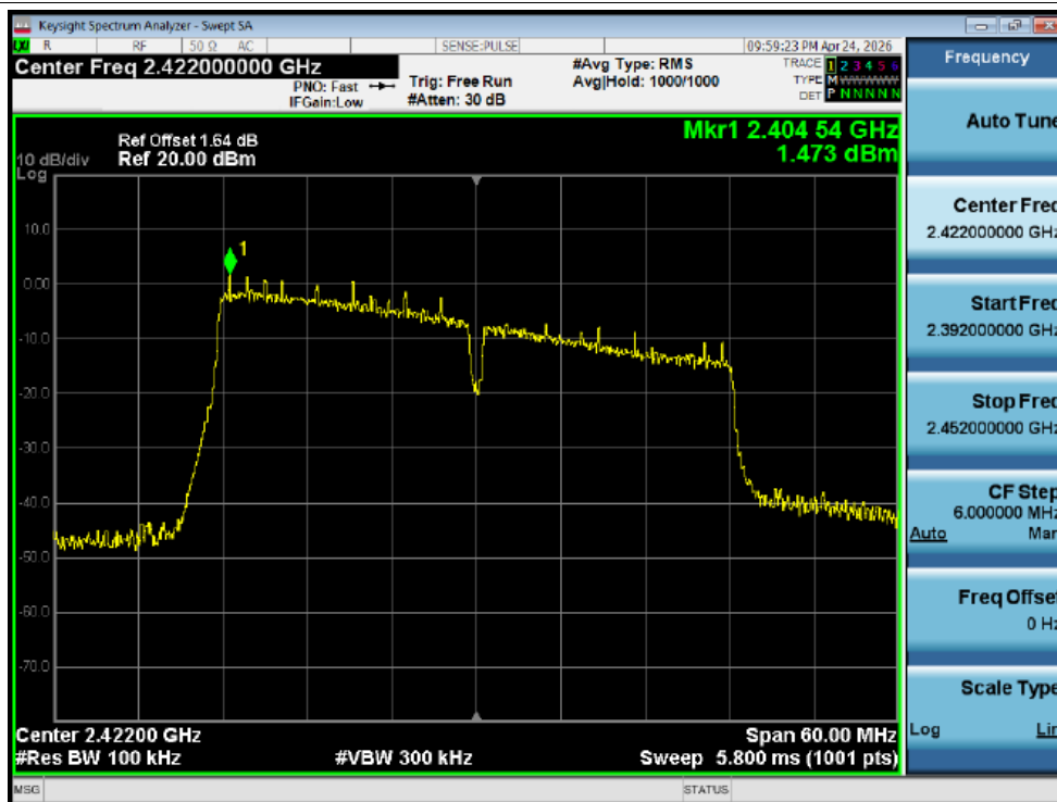
Band Edge NVNT n40 2422MHz Ant1 Ref
