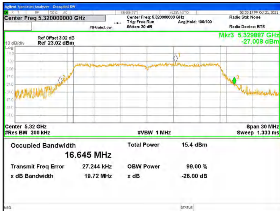
-26dB Bandwidth NVNT a 5500MHz Ant1
