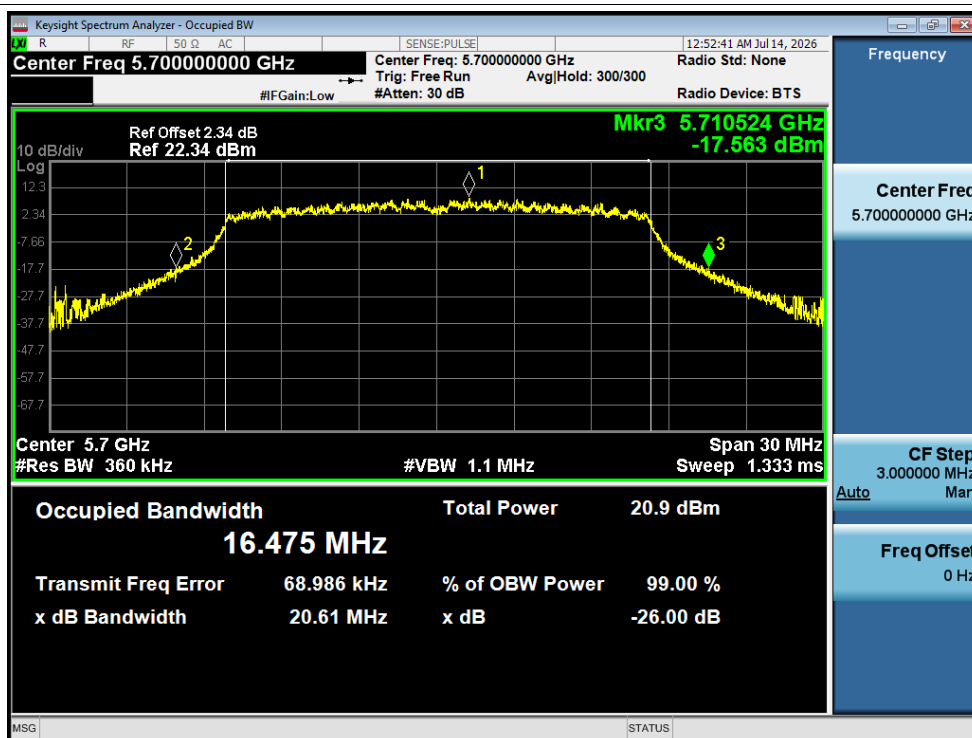
-26dB Bandwidth NVNT a 5700MHz Ant2
