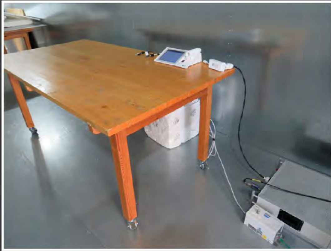
TEST SETUP - AC Mains - EUT CONFIGURATION 3
