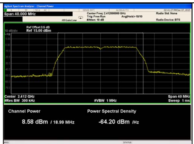
802.11g - AV Output power - Low CH 2412
