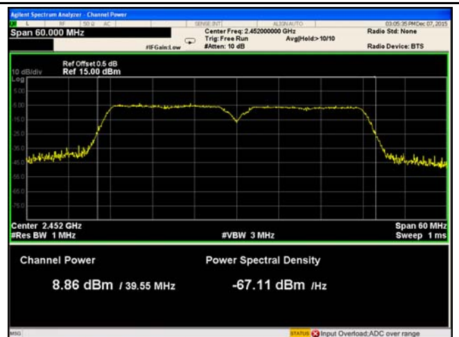
802.11n40 - AV Output power - High CH 2452
