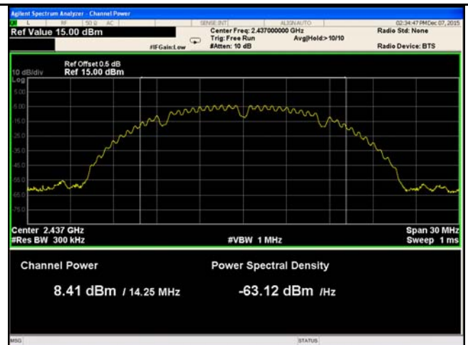
802.11b - AV Output power - Mid CH 2437
