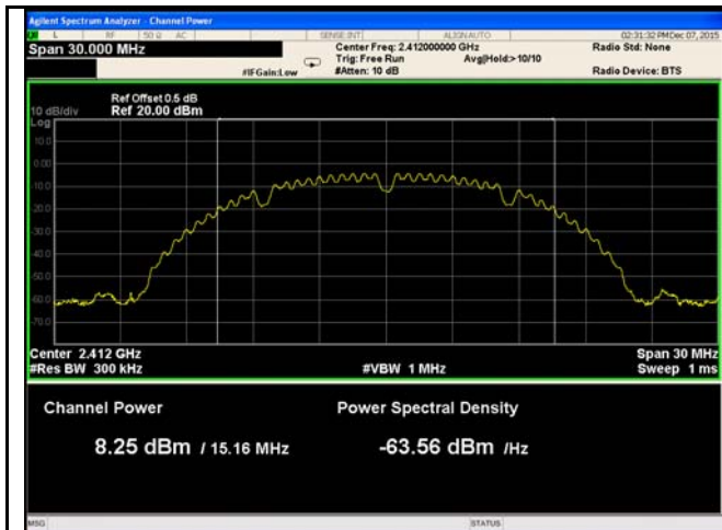
802.11b - AV Output power - Low CH 2412
