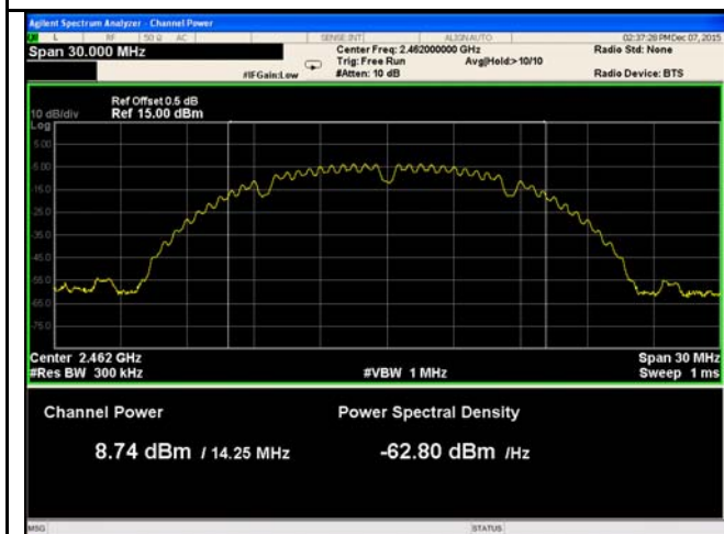
802.11b - AV Output power - High CH 2462
