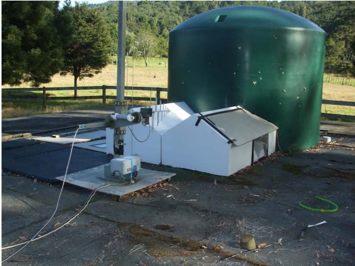
Schwarzbeck Log Periodic Antenna (300 - 2800 MHz)
