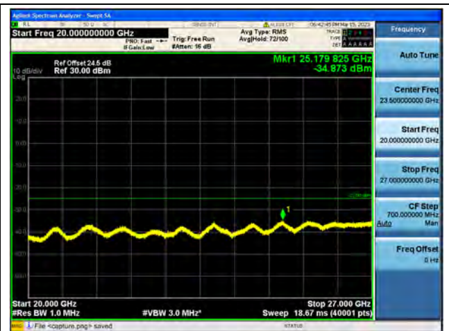
Band41-20G-27G / 20MHz / Low CH / QPSK
