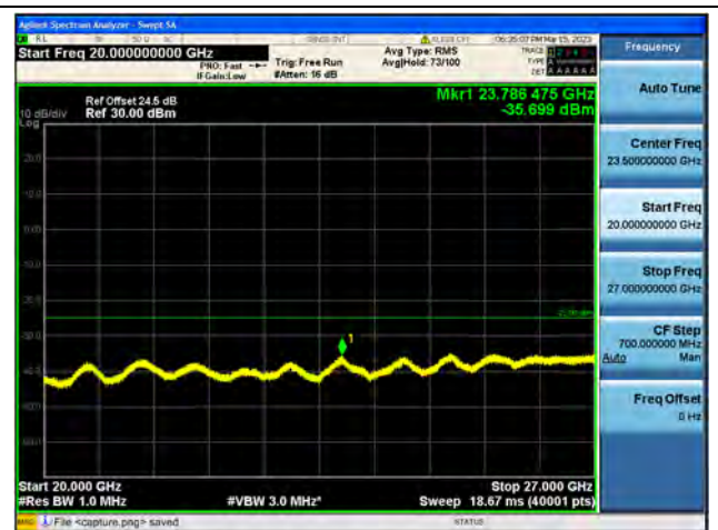
Band41-20G-27G / 10MHz / Low CH / QPSK
