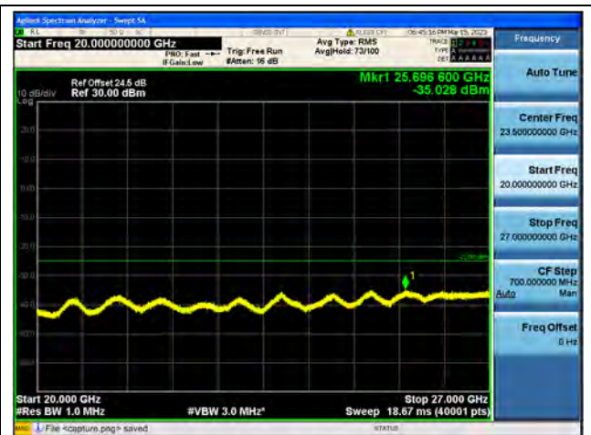
Band41-20G-27G / 20MHz / High CH / QPSK
