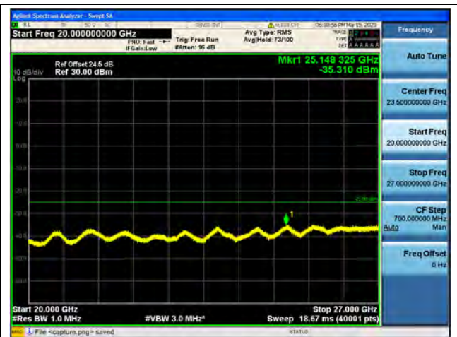
Band41-20G-27G / 15MHz / Low CH / QPSK
