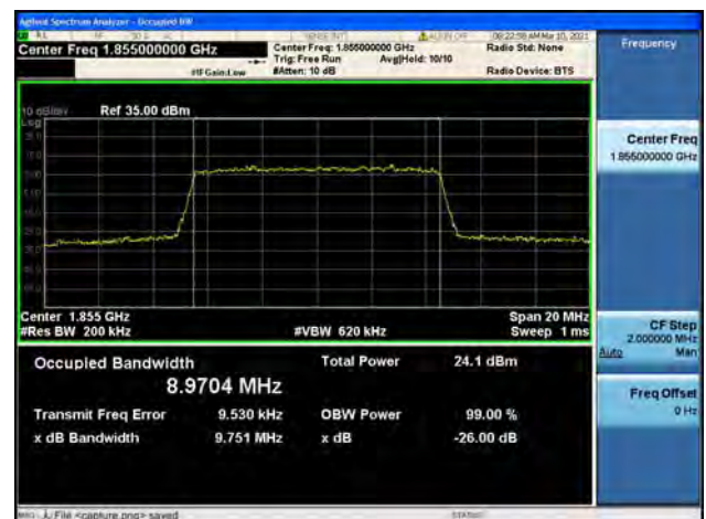
Band2 / 10MHz / Low CH / 64QAM
