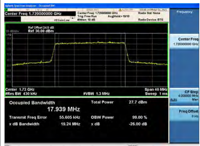
Band66 / 20MHz / Low CH / 64QAM
