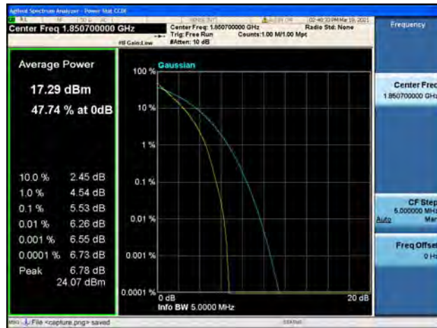
Band2 / 1.4MHz / Low CH / 64QAM
