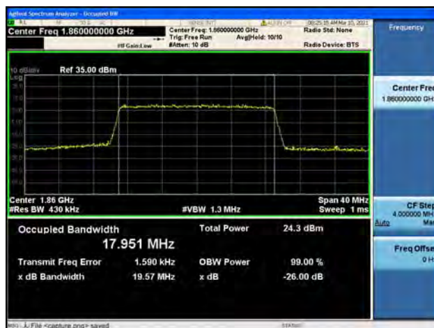
Band2 / 20MHz / Low CH / 16QAM
