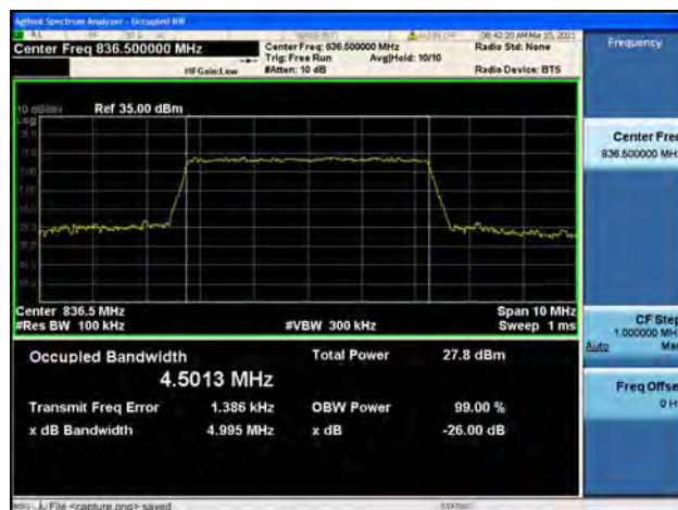
Band5 / 5MHz / Mid CH / 16QAM
