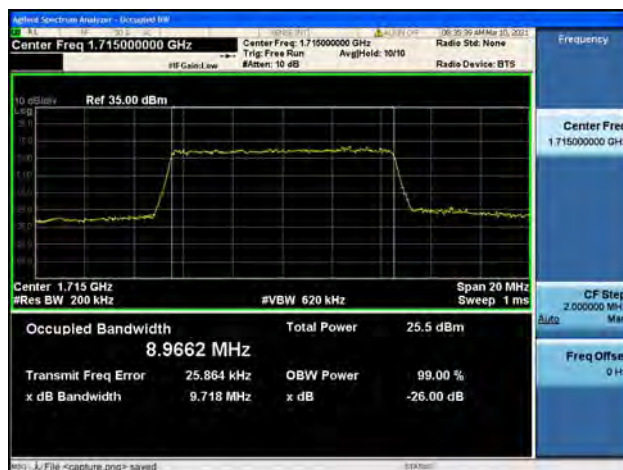
Band4 / 10MHz / Low CH / 16QAM
