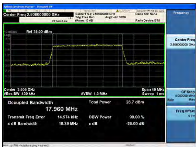
Band41 / 20MHz / Low CH / 64QAM
