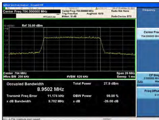
Band12 / 10MHz / Low CH / 16QAM
