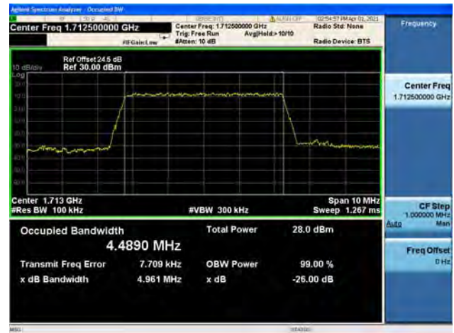
Band66 / 5MHz / Mid CH / QPSK
