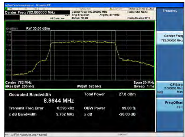
Band13 / 10MHz / Low CH / 64QAM
