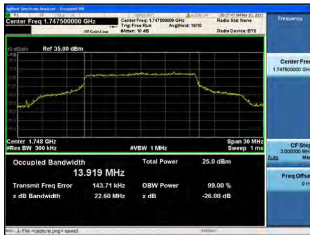
Band4 / 20MHz / Low CH / 16QAM
