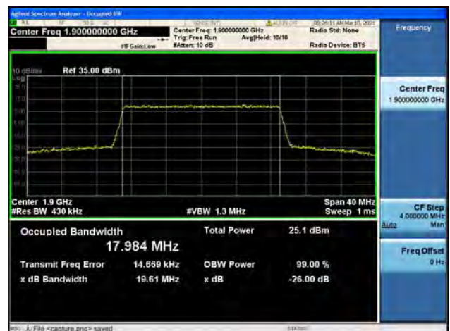
Band2 / 20MHz / High CH / 64QAM
