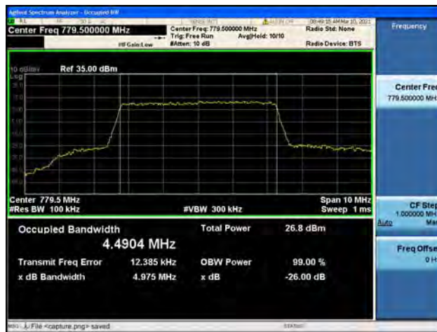
Band13 / 5MHz / Mid CH / 16QAM
